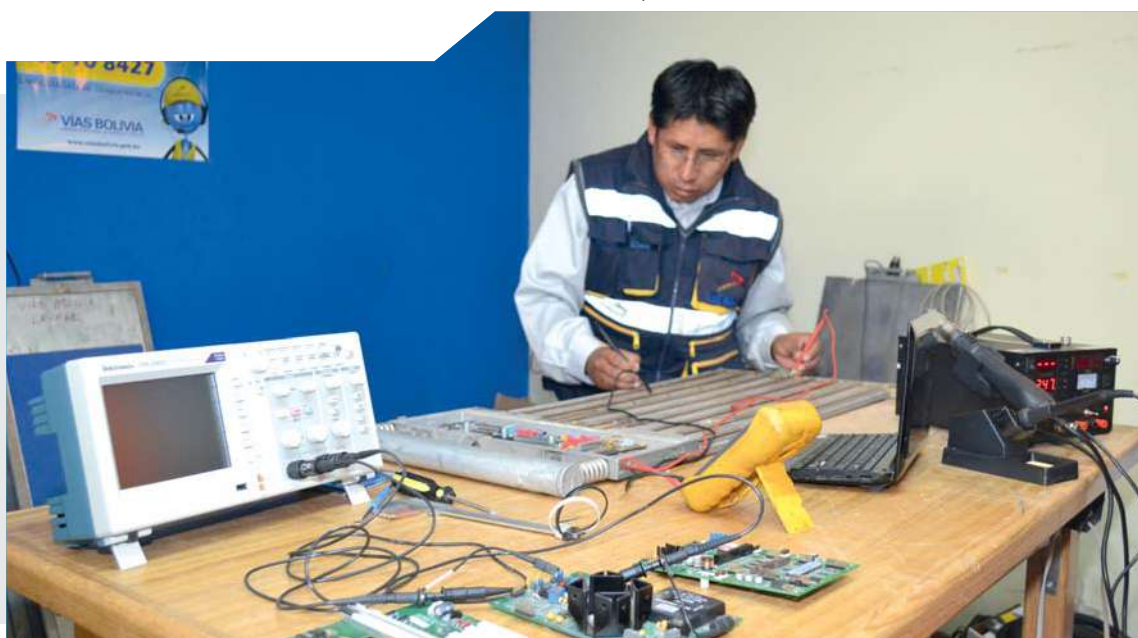
Técnico de la Unidad de Pesaje, trabajo de mantenimiento de una balanza PAT DAW
